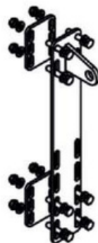
Pletina de fijación superior. Eje entre los escalones 250\text{mm} < e < 400\text{mm}
