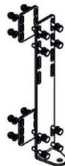
Pletina de fijación inferior. Eje entre los escalones 250\text{mm} < e < 400\text{mm}
