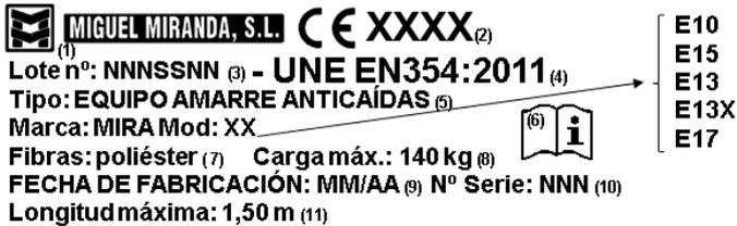
(1) Fabricante. (2) Organismo de Control del proceso de fabricación. (3) Número de serie/lote. (4) Norma y año que cumple. (5) Tipo de equipo y modelo. (6) Siempre leer y seguir las advertencias e instrucciones de uso. (7) Fibras. (8) Carga nominal máxima 140kg. (150 kg incluyendo herramientas y equipamiento. (9) Mes/año de fabricación. (10) Número de EPI dentro de cada lote. (11) Longitud del equipo.
