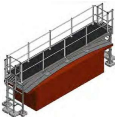
Pasarela sobre chapa perfilada
