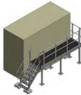
Plataforma anclada a un forjado de hormigón
